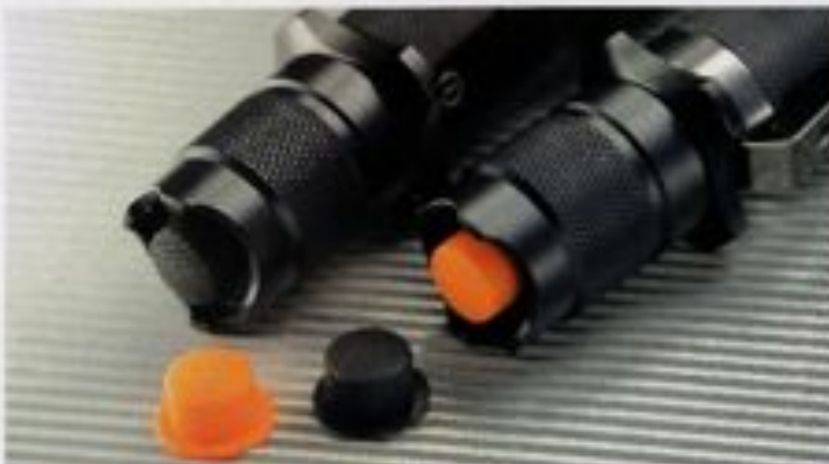
Sopra e sotto, il sofisticato gruppo di controllo dell'accensione con pulsante intercambiabile. La guarnizione ad anello protegge i punti critici
