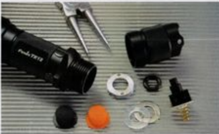
Sopra e sotto, il sofisticato gruppo di controllo dell'accensione con pulsante intercambiabile. La guarnizione ad anello protegge i punti critici
